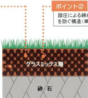
【グラスミックス工法断面図】
